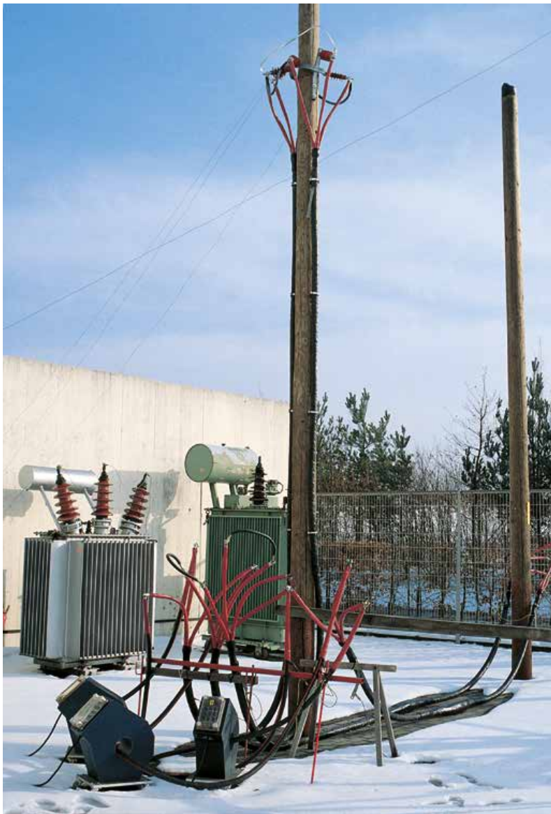
Badania osprzętu kablowego typu GUSJ i GUST na kablach o izolacji papierowej na napięcie 10 kV w centrum rozwoju Raychem
